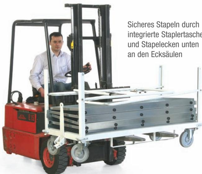
Sicheres Stapeln durch integrierte Staplertaschen und Stapelecken unten an den Ecksäulen
